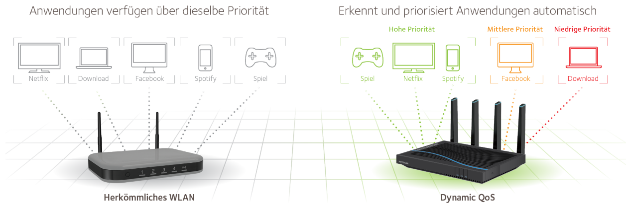
Abbildung 13. Das dynamische QoS optimiert den Internet-Datenverkehr durch Priorisierung von sich überschneidenden Anforderungen
