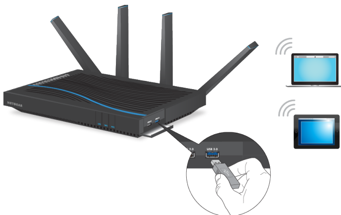
Abbildung 14. An der Seite des Routers befinden sich ein USB-3.0- und USB-2.0-Port.
