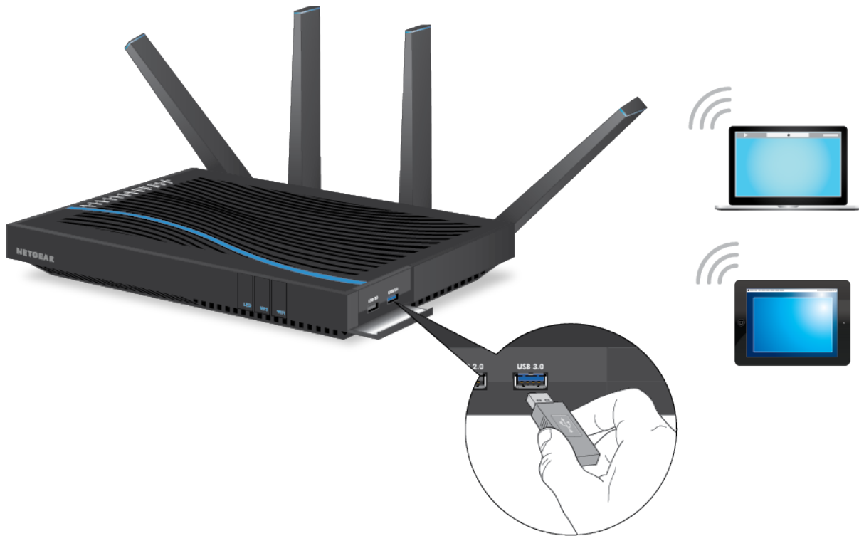
Abbildung 3. Auf der rechten Seite befinden sich ein USB-3.0-Anschluss und ein USB-2.0-Anschluss.
